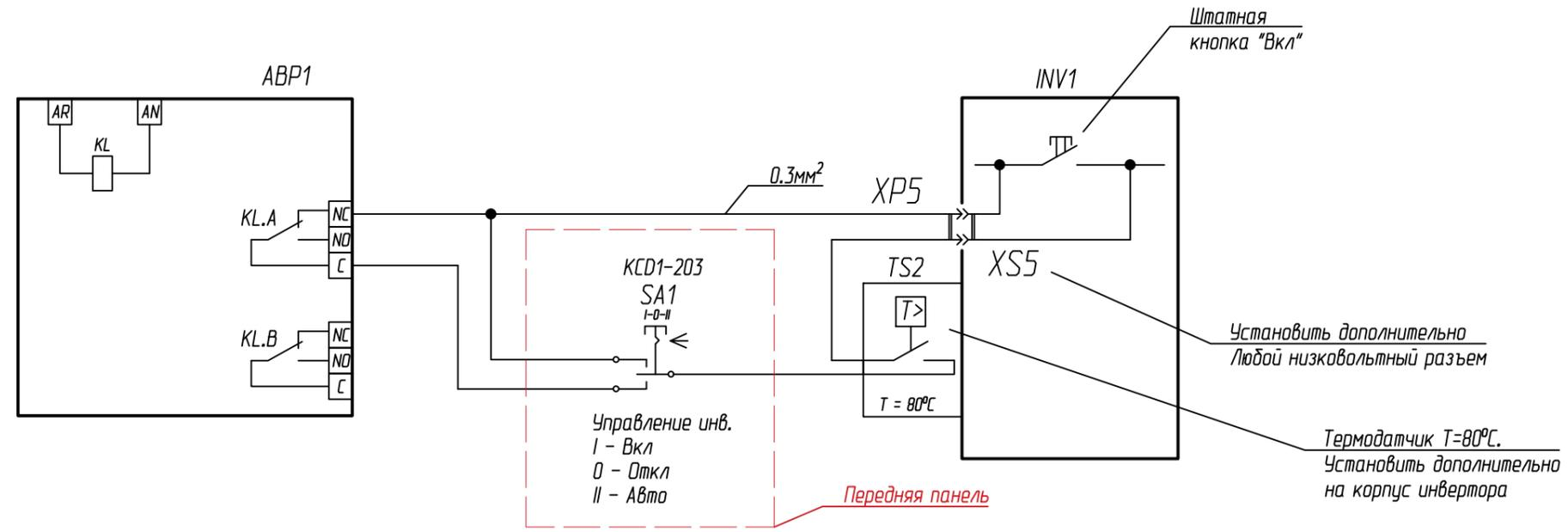
Термодатчик T=80°C. Установить дополнительно на корпус инвертора
